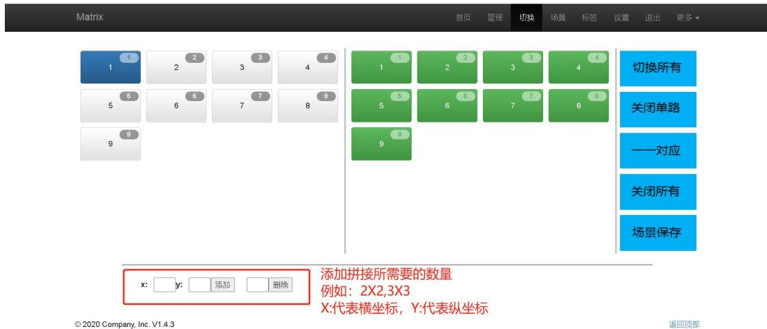
如图所示: 找到红色图框添加拼接所需要的参数, 例如: 2X2 拼接墙 3X3 拼接墙, X:代表横坐标 Y: 代表纵坐标
