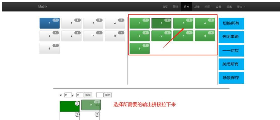
选择所需要的输出拼接拉下来, 到框中所选的区域根据现场的实际要求来做调整
