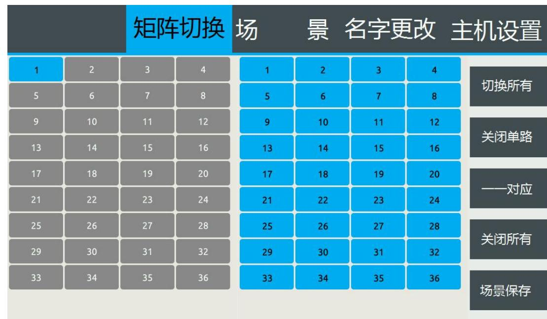
左边 1-36 是输入区，分别对应矩阵主机的 1-36 输入槽位，右边 1-36 是输出区，分别对应矩阵主机的 1-36 输出槽位。
