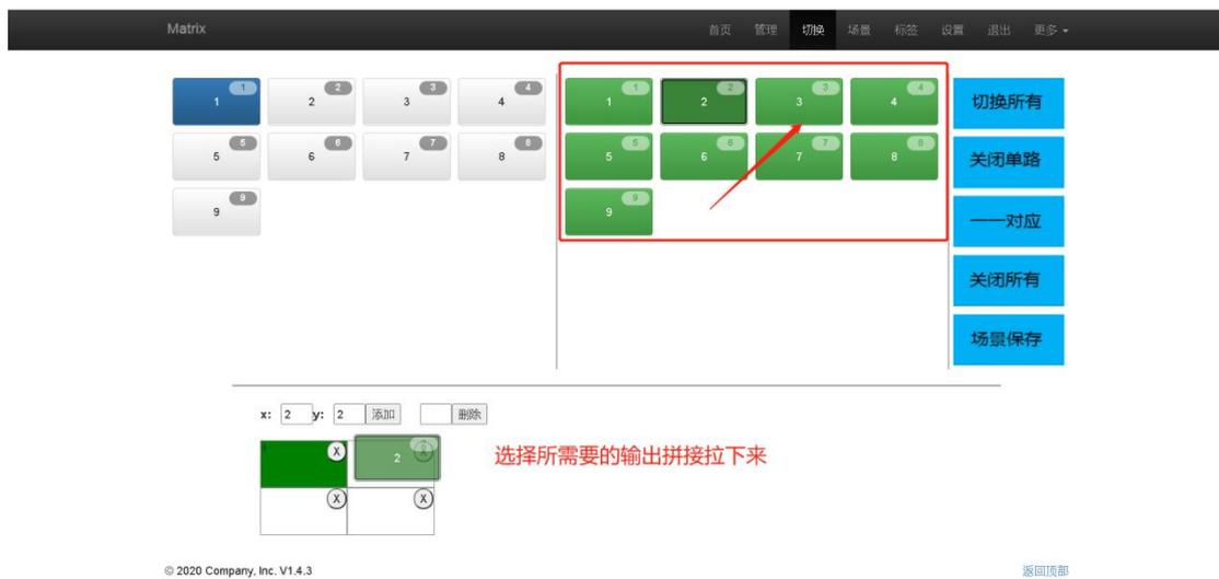
选择所需要的输出拼接拉下来，到框中所选的区域根据现场的实际要求来做调整
