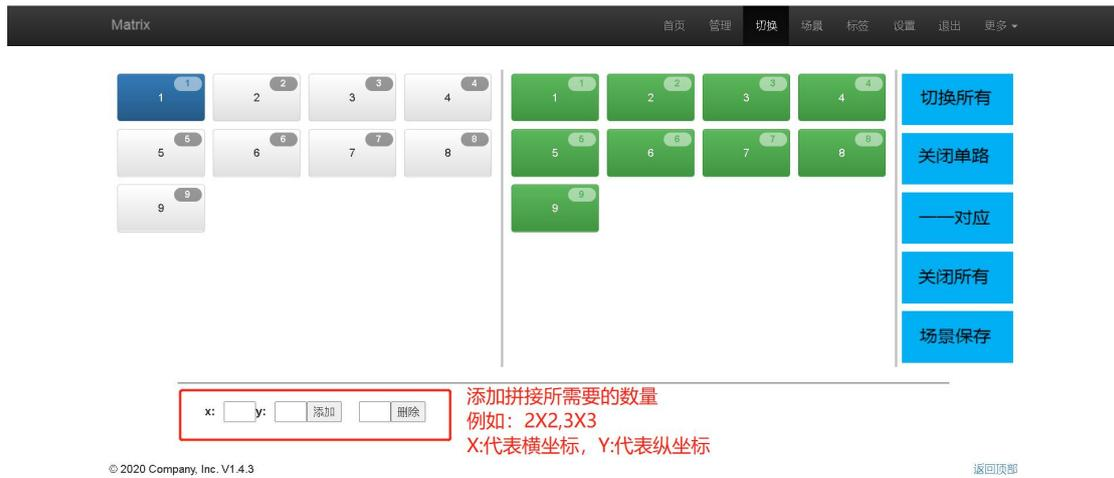
如图所示：找到红色图框添加拼接所需要的数量，例如：2X2 拼接墙 3X3 拼接墙，X:代表横坐标 Y: 代表纵坐标
