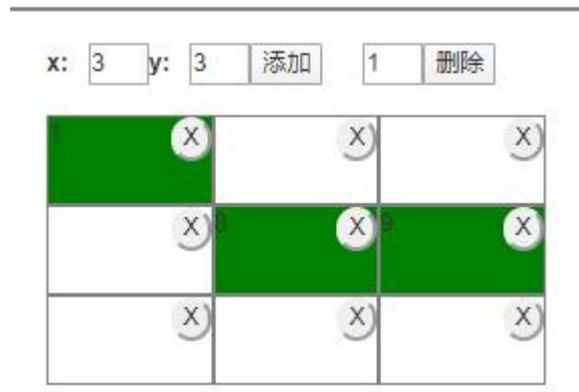
5.一个 3X3 的拼接, 第一路输出拼到左上角位置 (1), 启用拼接; 第 7 路输出卡拼到右侧中间位置 (6), 关闭拼接; 第 8 路输出卡拼接到正中间位置 (5), 启用拼接; 第 9 路拼接右侧中间位置 (6), 关闭拼接。
