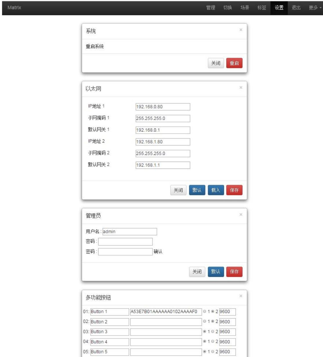
设置界面一共有四个区域，最上面的为系统重启功能，一般在修改矩阵一些配置后需要重启（如：IP 地址，用户名登录密码），第二个区域为 IP 地址修改，可以根据现场的实际需求更改 IP 地址，（注意：两个网络的 IP 地址不能在一个网段），第三个区域为用户名密码更改；最后一个区域是多功能按钮设置区域。
