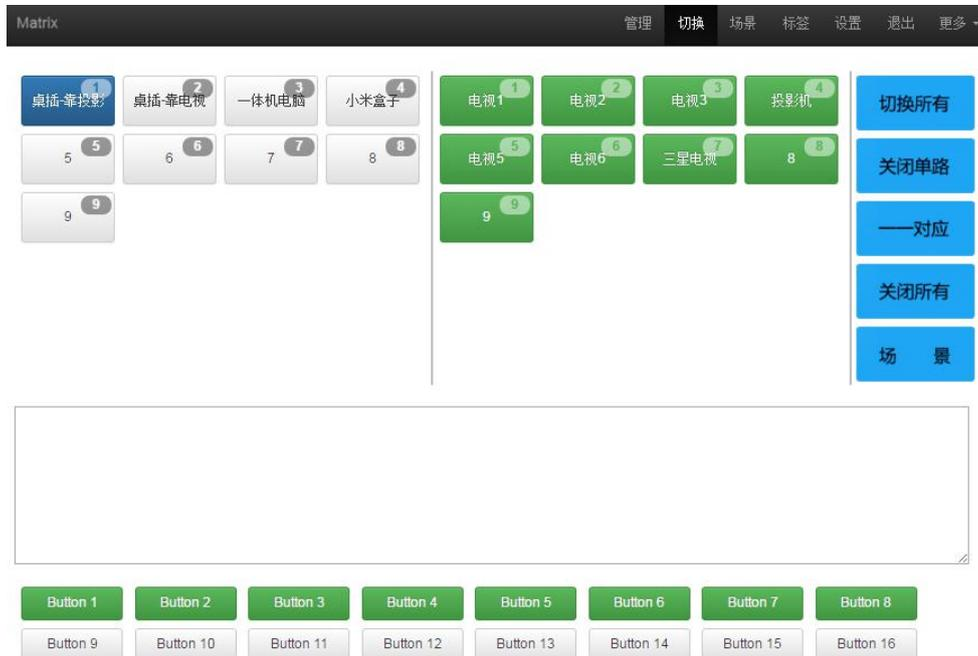
竖线左边区域为输入区域,竖线右边区域为输出区域;最右边有 5 个快捷按钮,从上往下分别为**切换所有**、**关闭单路**、**一一对应**、**关闭所有**、**场景**。(所有的输入输出端口均可改名,见命名操作说明);最下面为多功能按键区域,通过简单的设置,可以通过串口控制外围设备,如投影机的开关。无设置时是场景的调用快捷按钮。(详情见“设置”多功能按键设置
