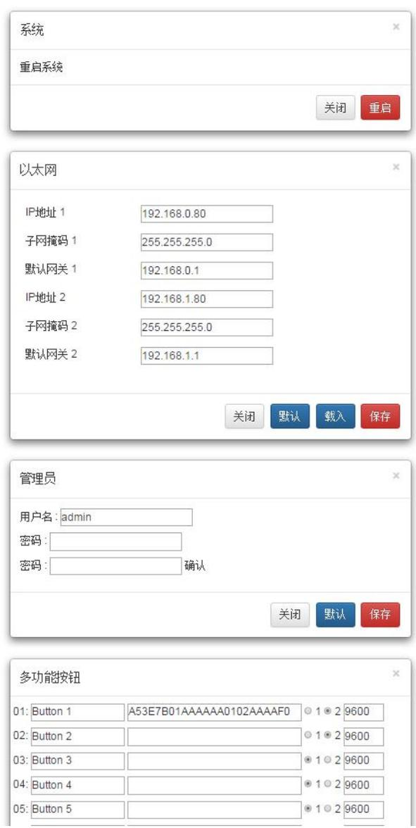
设置界面一共有四个区域，最上面的为系统重启功能，一般在修改矩阵一些配置后需要重启（如：IP 地址，用户名登录密码），第二个区域为 IP 地址修改，可以根据现场的实际需求更改 IP 地址，（注意：两个网络的 IP 地址不能在一个网段），第三个区域为用户名密码更改；最后一个区域是多功能按钮设置区域。
